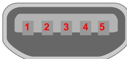
Рис. 2.2 Разъем micro-USB
